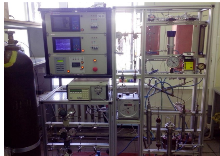
Установка для изучения процесса гидроочистки дизельных топлив, ИК 06-14
